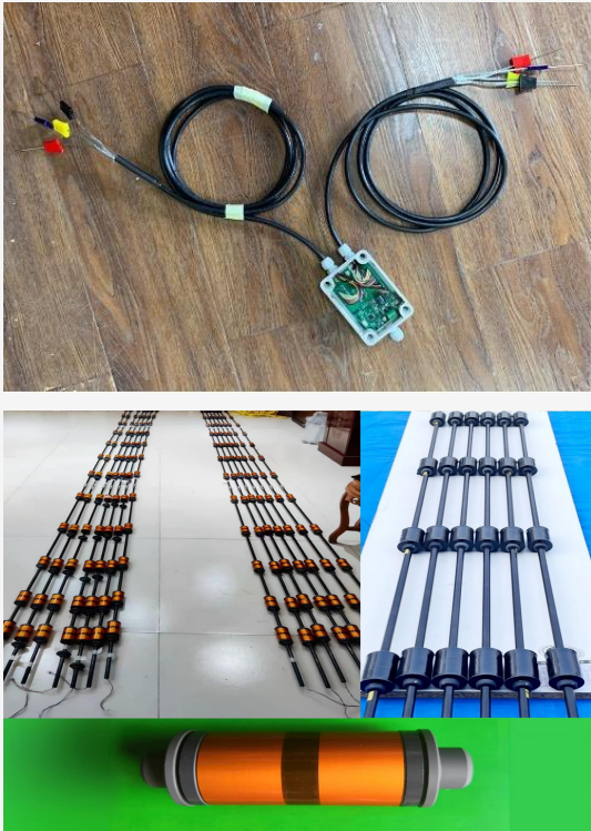
自主研发全球唯一可测6米深的土壤水分传感器
